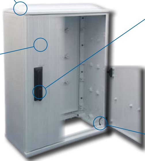
Dreipunkt-Schließmechanismus mit Schwenkhebel aus schlagfestem Isolierstoff mit Aufnahmen für Profil-Einbau-Halbzyylinder. Auf Wunsch können auch andere Schlösser – z. B. 2 Profi-Halbzyylinder – eingebaut werden.
