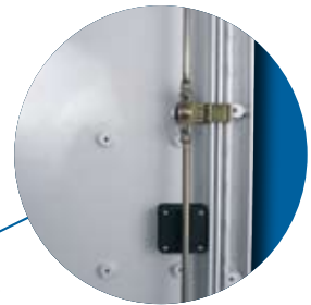
Dreipunkt-Schließmechanismus mit Schwenkhebel aus schlagfestem Isolierstoff mit Aufnahmen für Profil-Einbau-Halbzylinder. Auf Wunsch können auch andere Schösser – z. B. 2 Profi-Halbzylinder – eingebaut werden.
